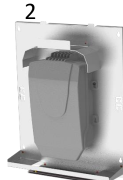
2 Monter BUDI-boksen på bag-pladen. Kør overlængde på kablerne rundt om kabel-holderne. Evt. aflastning med strips/velcro kan laves i begge sider. Der er stor kabelgennemførringshul i bunden og 2 mindre i hver side af toppladen.
